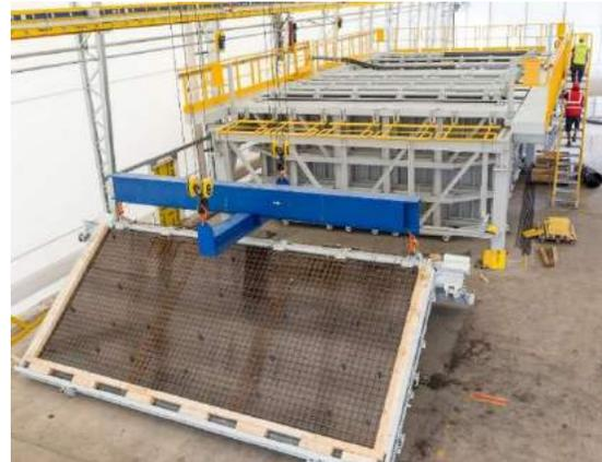
Mobile Feldfabrik zur industriellen Fertigung von Betonfertigteilen
