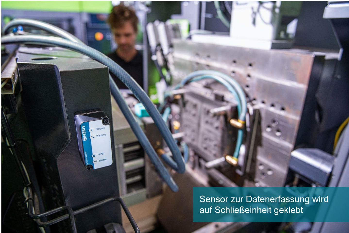
Sensor zur Datenerfassung wird auf Schließeinheit geklebt
