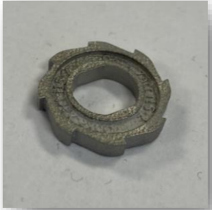
Zackenring als Einbauteil für erste Testbaugruppen aus 1.4404
