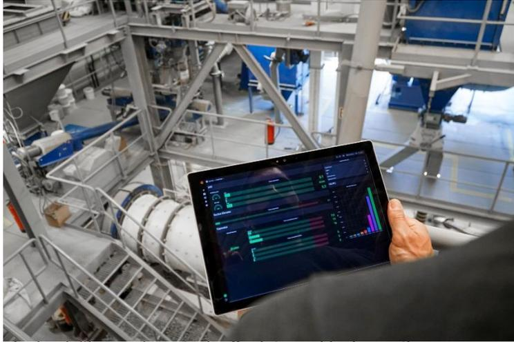
Zustandsüberwachung in der Gesteinsmahlanlage mit Mobilgerät
