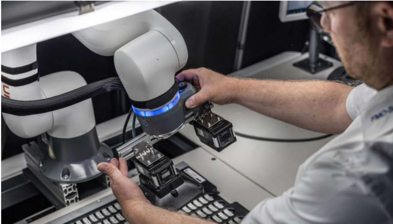
Frisch gelaserte DataMatrix-Codes auf Vollständigkeit überprüfen – bei FMO Surface ein Fall für den Cobot
