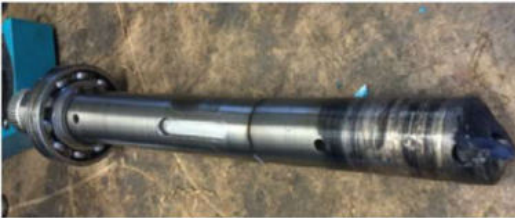
Ritzel- und Zahnkranzfresser, Gleitlager ausgebrannt.
