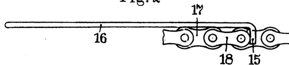
1. Vorrichtung (10) zum Aufsetzen einer Kette auf das Kettenblatt eines Fahrrads, mit
