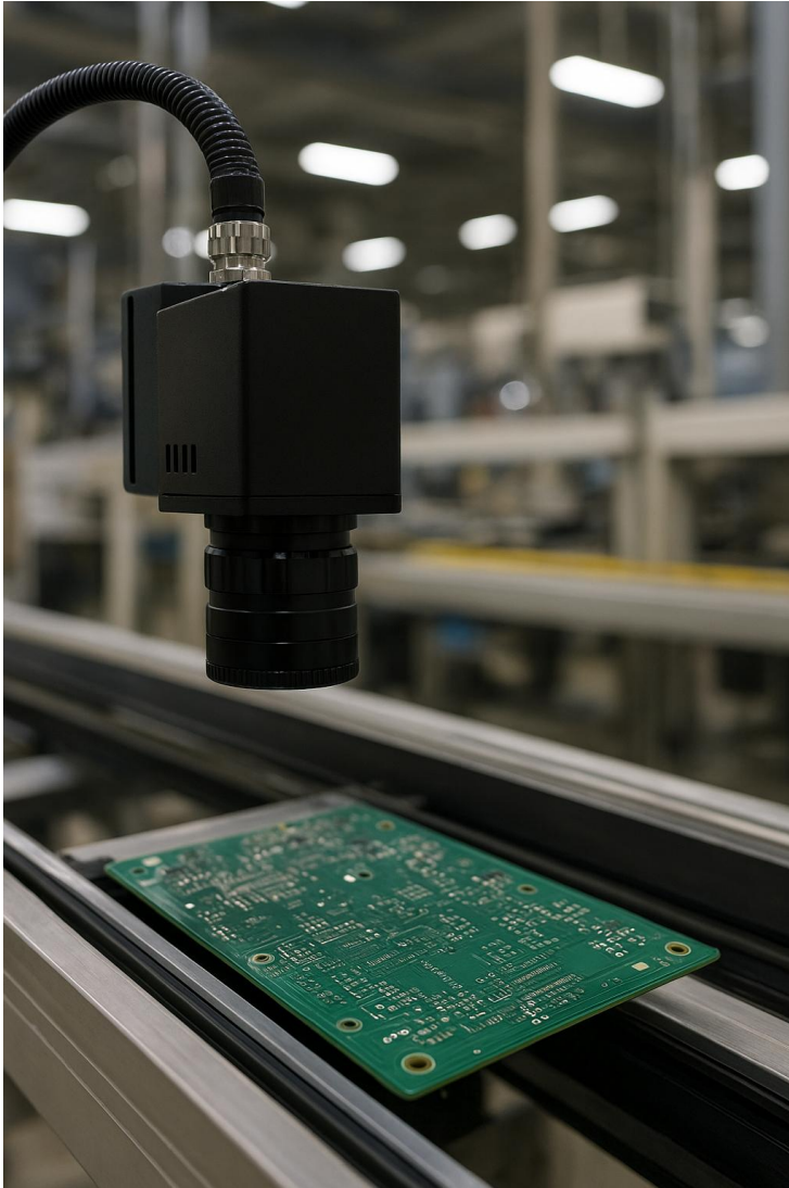
Visualisierung einer PCB Überprüfung
